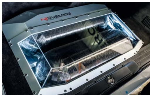
Wasserstoff-Tanks von Magna unter dem Kofferraumboden, detaillierte Anzeigen zum Betrieb des FCREEV.
