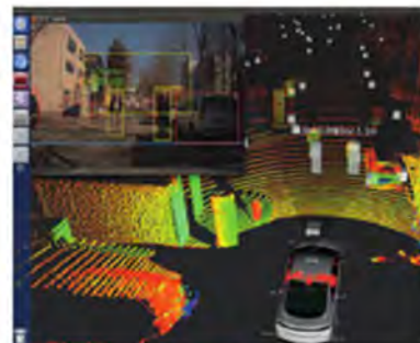
AUGEN UND OHREN DES AUTOS. Mit welchen Sensoren ein selbstfahrendes Auto ausgestattet ist und was es dabei dank Laserscanner sieht (o.).
