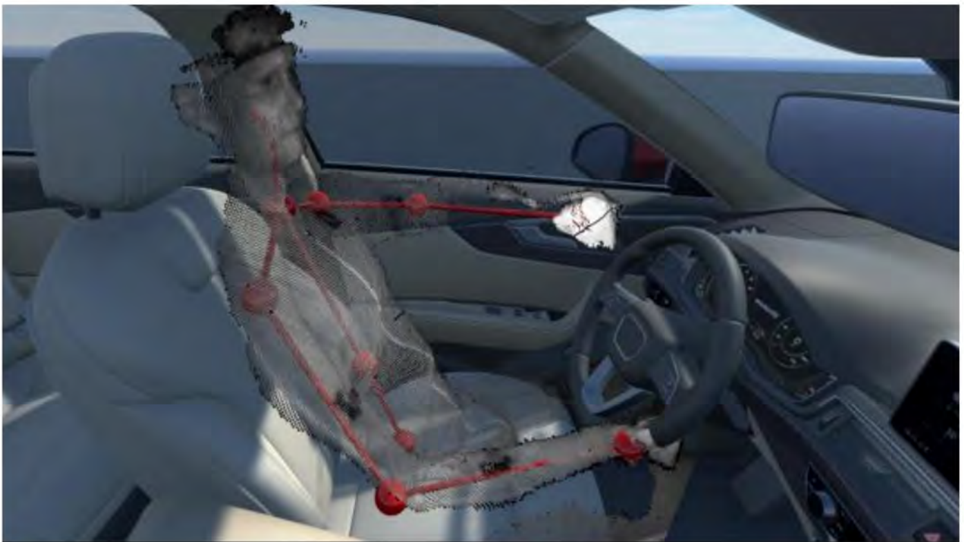
So sehen Sensoren die Position eines Menschen am Fahrersitz eines autonomen Fahrzeugs © Bild: emotion3D
