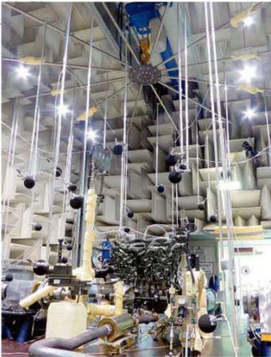
Prüfstand des Virtual Vehicle: Hier werden Motorgeräusche analysiert
