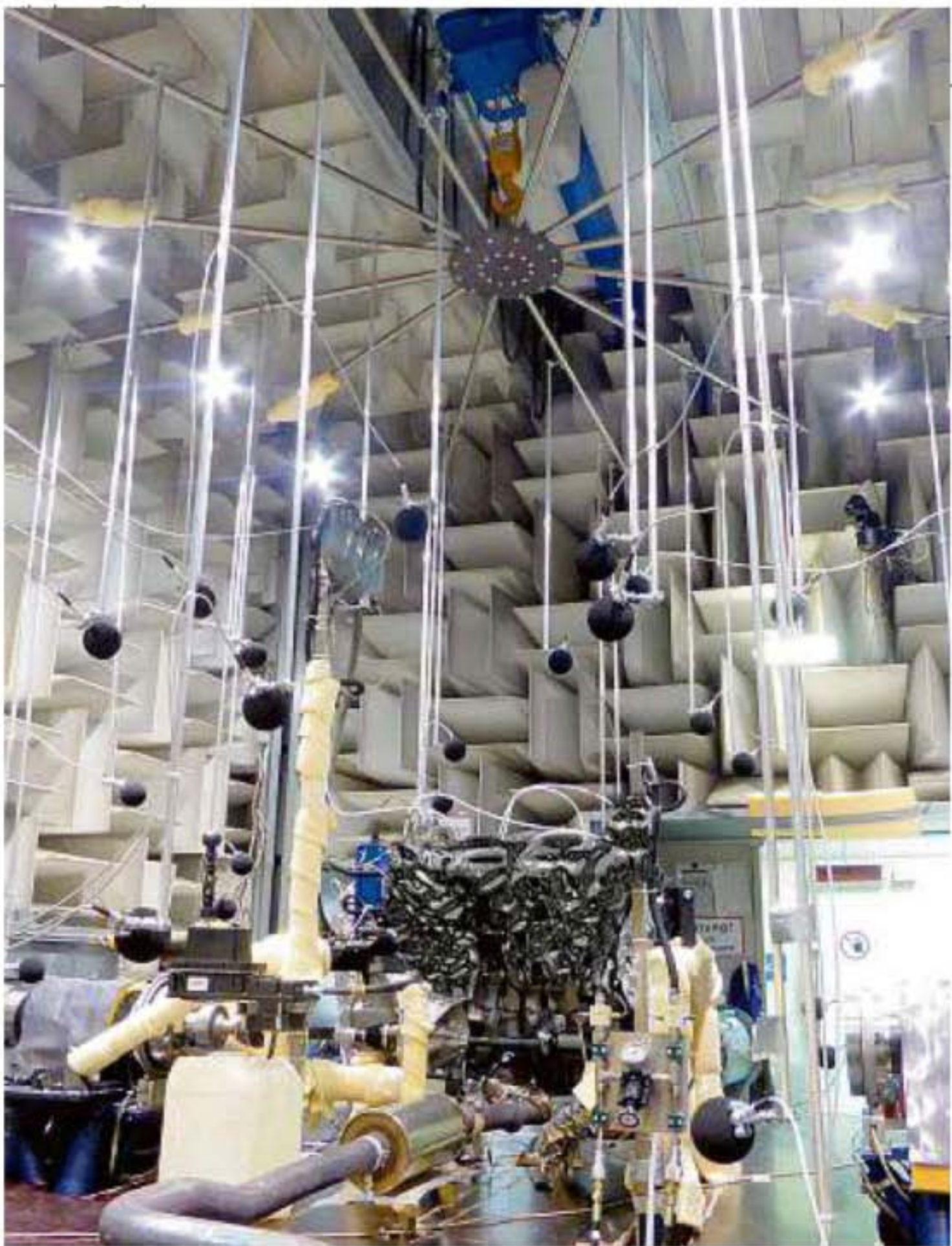
Prüfstand des Virtual Vehicle: Hier werden Motorgeräusche analysiert
