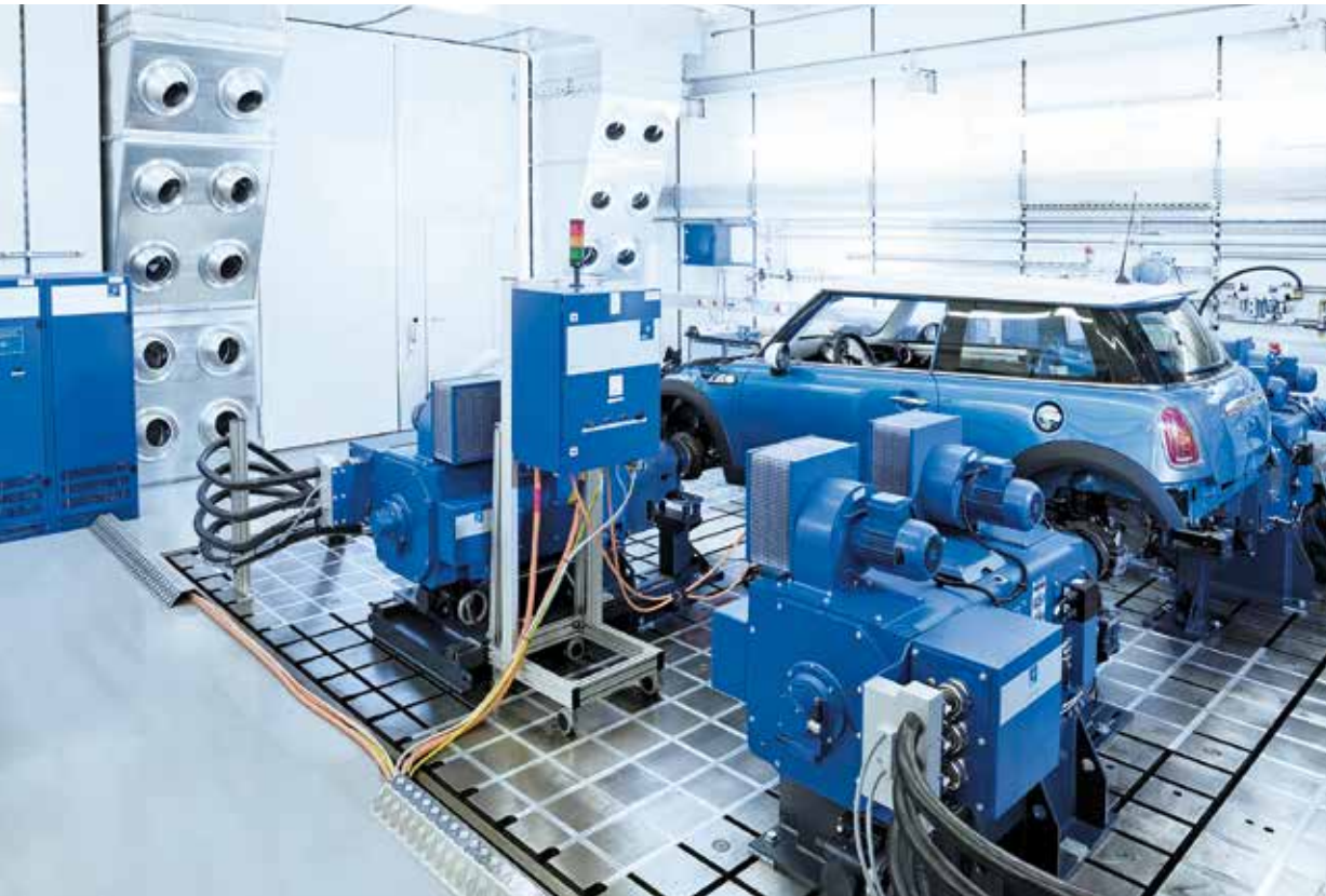
Antriebsstrang und Testsystem im Eingriff.
