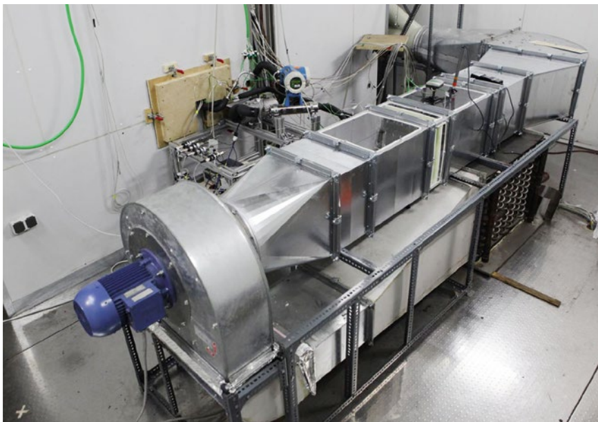
BILD 1 Vermessung des Prototyps einer CO 2 -Klimaanlage am Systemprüfstand
