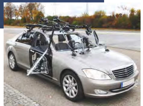
Ein Versuchsfahrzeug für Probandentests: Ein System zur Erfassung der Insassenkinematik ist auf dem Fahrzeug montiert
