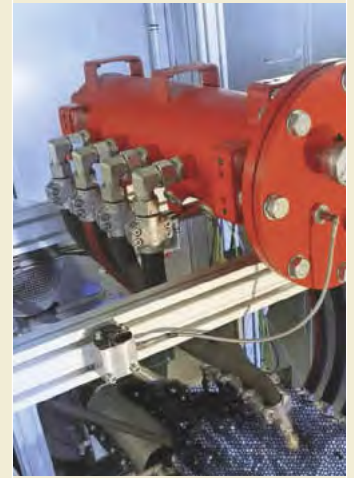
Der prämierte Motorprüfstand Frida (Friction Dynamometer) Bild: Virtual Vehicle
