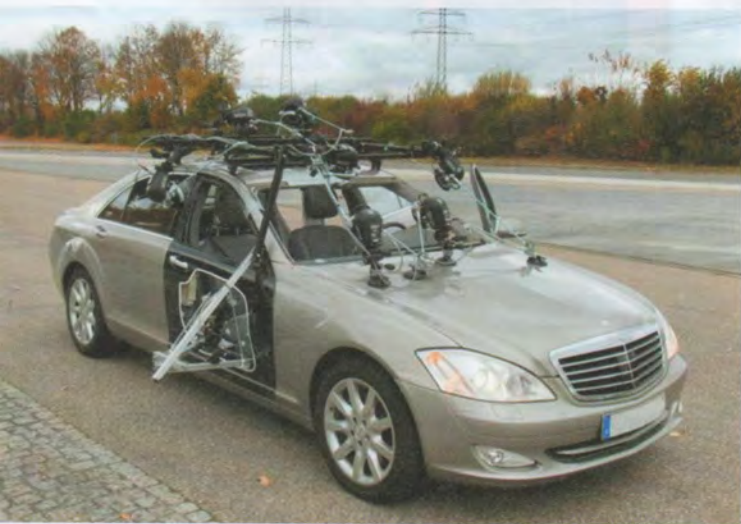
Ein Versuchsfahrzeug für Probandentests: Ein System zur Erfassung der Insassenkinematik ist auf dem Fahrzeug montiert.
