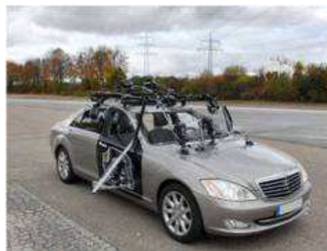
Ein Versuchsfahrzeug für Probandentests: Ein System zur Erfassung der Insassenkinematik ist auf dem Fahrzeug montiert.
