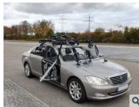
Versuchsfahrzeug für Probandentests - Ein System zur Erfassung der Insassenkinematik ist auf dem Fahrzeug montiert. VIRTUAL VEHICLE
