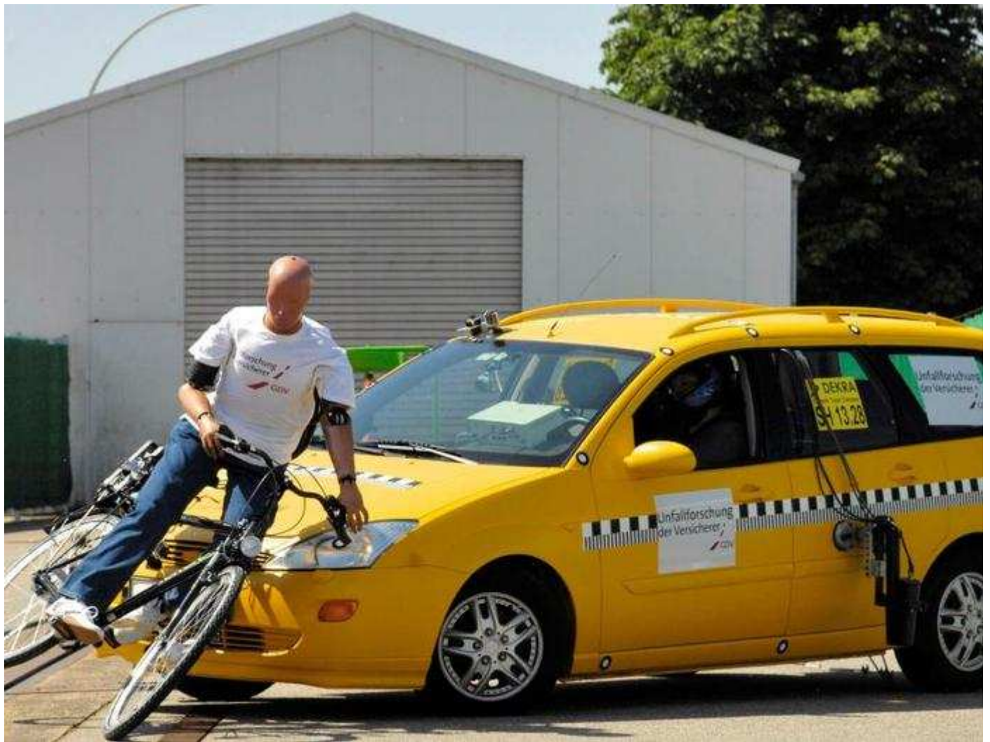
Für jeden Zweck eine eigene Puppe: Je nach Unfallart und zu simulierender Personengröße kommen unterschiedliche Crashtest-Dummys zum Einsatz. Foto: UDV (Bild: dpa)
