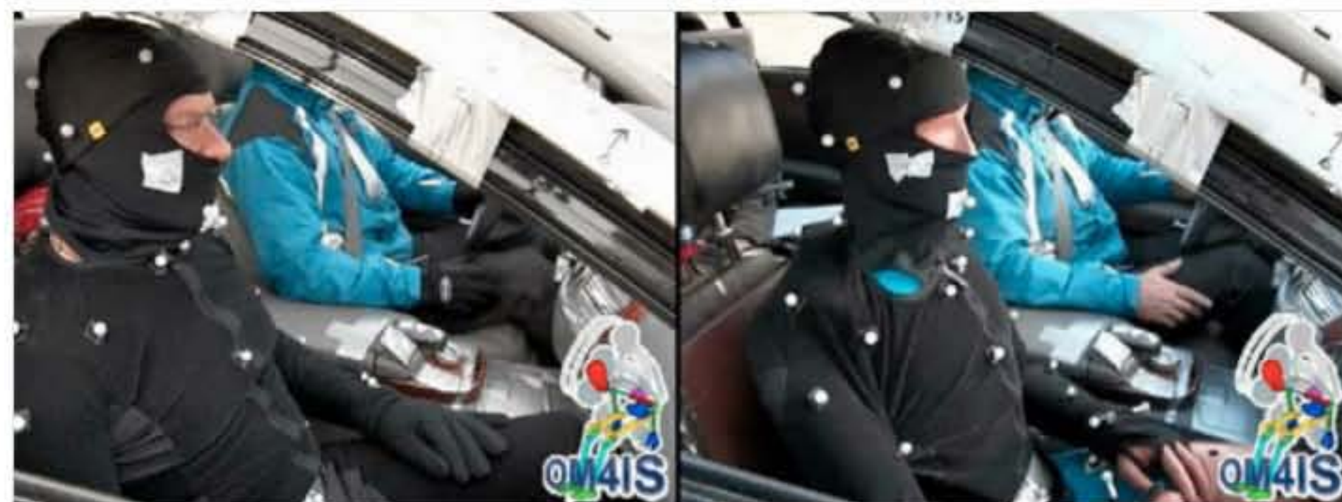
Im Rahmen des Projektes OM4IS wurden auch Probanden einem Notbremsmanöver mit 12 km/h und einem Spurwechselmanöver mit 50 km/h ausgesetzt, wobei jeweils Beschleunigungen von 1 g in Längs- bzw. Querrichtung erreicht wurden. - Bild: Virtual Vehicle
