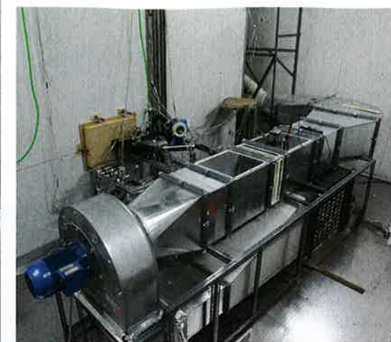
In einer Klimakammer an der TU Graz wird der Prototyp einer neuartigen CO 2 -Klimaanlage auf Herz und Nieren getestet.
